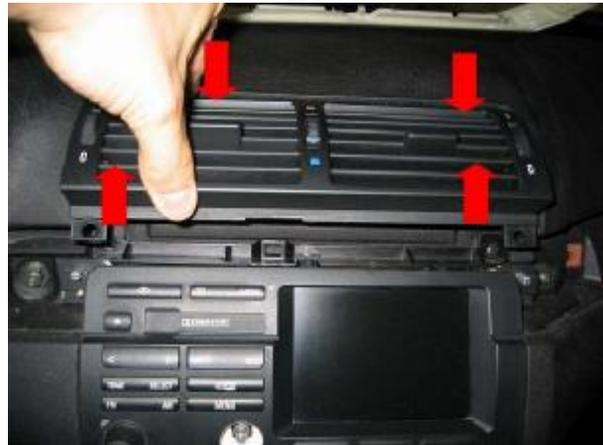
Das blaue Kabel der Frischluft-Klappen-Verstellung kann man dran lassen, es ist genügend lang, so dass man die Düse oben aufs Armaturenbrett legen kann.
