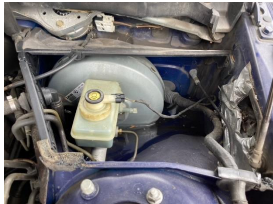
Blick auf den BKV. Hier sieht man wie bei mir Wasser steht. Das ist schlecht 😞
