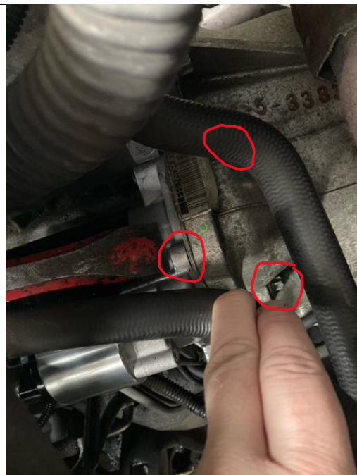
Hier sieht man bereits den neuen Anlasser (aber das ist egal – es soll in diesem Bild nur um die Position gehen). Es sind 2 Schrauben zu lösen (Kreis oben hinter dem Schlauch) und Kreis unten. Der mittlere Kreis links markiert den Führungsdorn.
