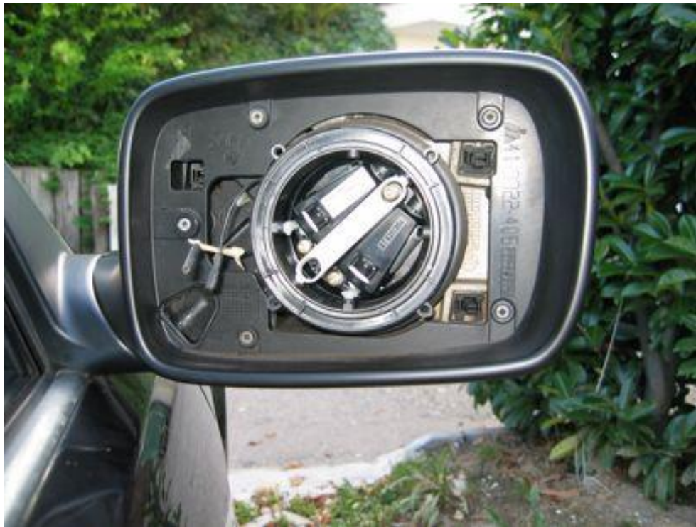
Originalspiegel rechts – Spiegelmotor mit Verstellachsen nach links und unten verbaut.
